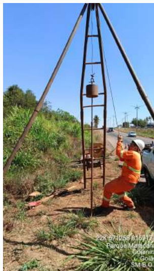
Foto 02 - Vista da execução da sondagem.
